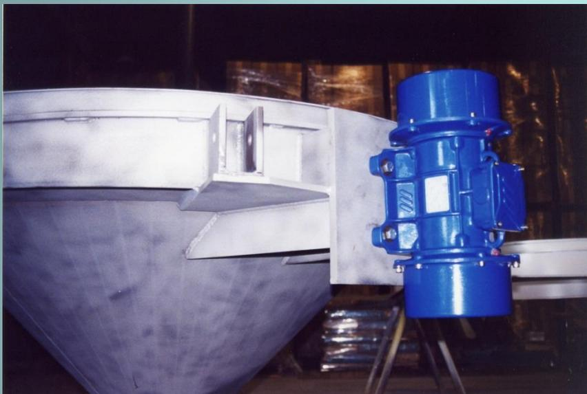
Устройство для ускорения выпуска продукции из силоса или бункера
