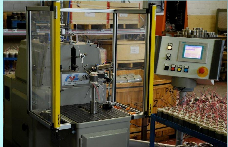
Обмотка электромоторов в нашем специализированном
