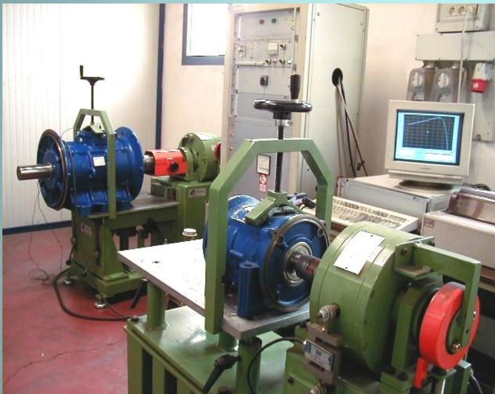
Весь модельный ряд проходит электрические и механические испытания в нашей лаборатории на специальных вибростендах в том числе и с применением электромагнитных тормозов.
